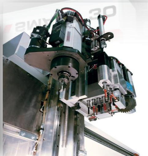
Unidade de perfuração
